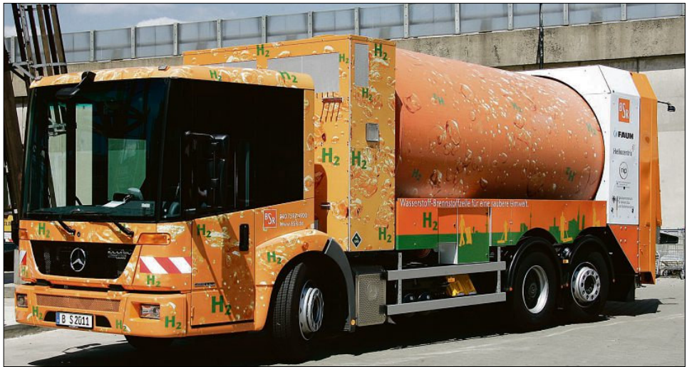
In Berlin haben jetzt die Berliner Stadtreinigungsbetriebe (BSR) das weltweit erste Wasserstoff-Brennstoffzellen-Müllfahrzeug in Betrieb genommen. Mit der Berliner Firma Heliocentris Energiesysteme GmbH und dem Aufbautenhersteller Faun wurde – gefördert durch das Bundesverkehrsministerium – ein Fahrzeug entwickelt, das deutlich leiser ist und bis zu 30 Prozent weniger Diesel verbraucht. Die Brennstoffzellen treiben die Ladeanlage an. FOTO BSR
